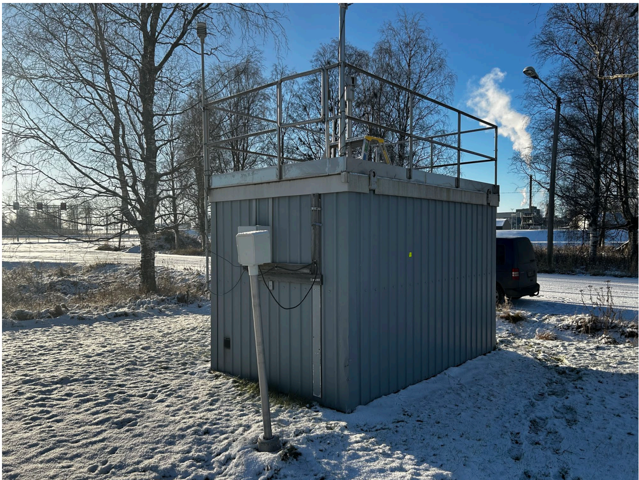
Kuva 13. Ilmanlaadun mittausasema Kemissä Metsä Fibren tehdasalueen lähistöllä. Ulkoilma imetään mittalaitteisiin kontin katolla sijaitsevien näytteenottimien läpi. Lisäksi katolla on säänmittausanturi. Valokuva: Toni Mattila.
