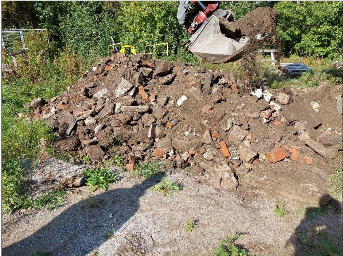
Kuva 2. Täyttöalueen koekuopassa KK5 havaittiin runsaasti rakennusjätettä. Samanlaista jätettä havaittiin myös koekuopassa KK8. (4.9.2024)
