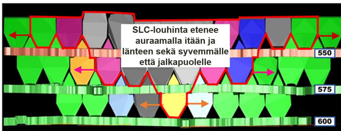
Kuva 2. Jännityskentän ohjaamiseksi SLC-louhinnan on edettävä systemaattisesti auraamalla itään ja länteen sekä syvemmälle että jalkapuolelle.
