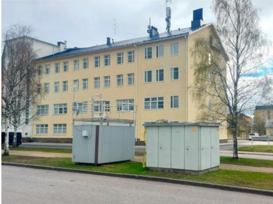
Kuva 17. Ilmanlaadun mittausasema Kemin keskustassa kuvassa oleva vasemman puoleinen harmaa kontti, jossa on turvakaiteet katolla.. Ulkoilma imetään mittalaitteisiin kontin katolla sijaitsevien näytteenottimien läpi. Lisäksi katolla on säänmittausanturi. Valokuva: Matias Saunamäki & Mika Vestenius.
