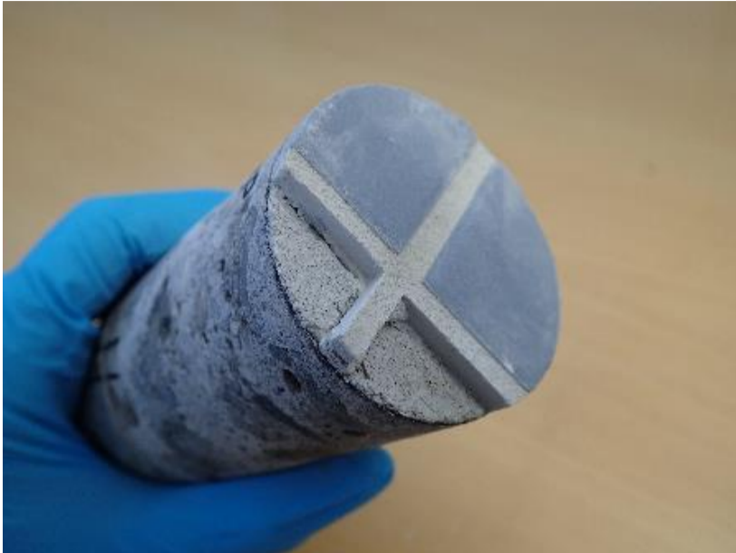
Kuva 126. Laatoitusten saumalaastit ovat pääosin hyväkuntoiset
