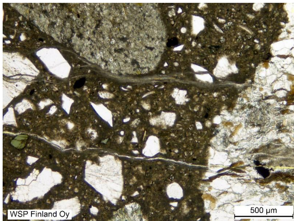
Kuva 2. Näyte WKU9, reagoanut grauvakka (oik.) ja siitä säteilevää silikageelitäytteistä säröilyä.
