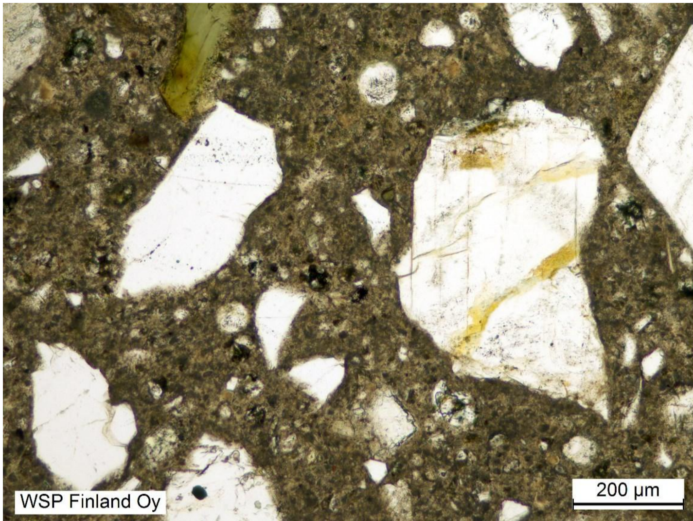
Kuva 6. Näyte WKU11, ettringiittikiteytymistä umpeutuneita huokosia betonissa.
