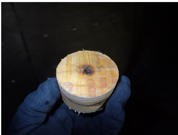
Kuva 11. Vahvistuslevystä otettu näyte paljastaa ettei liimaus ole onnistunut. Vahvistuksen liittävaikutus on naulaliitosten varassa.
