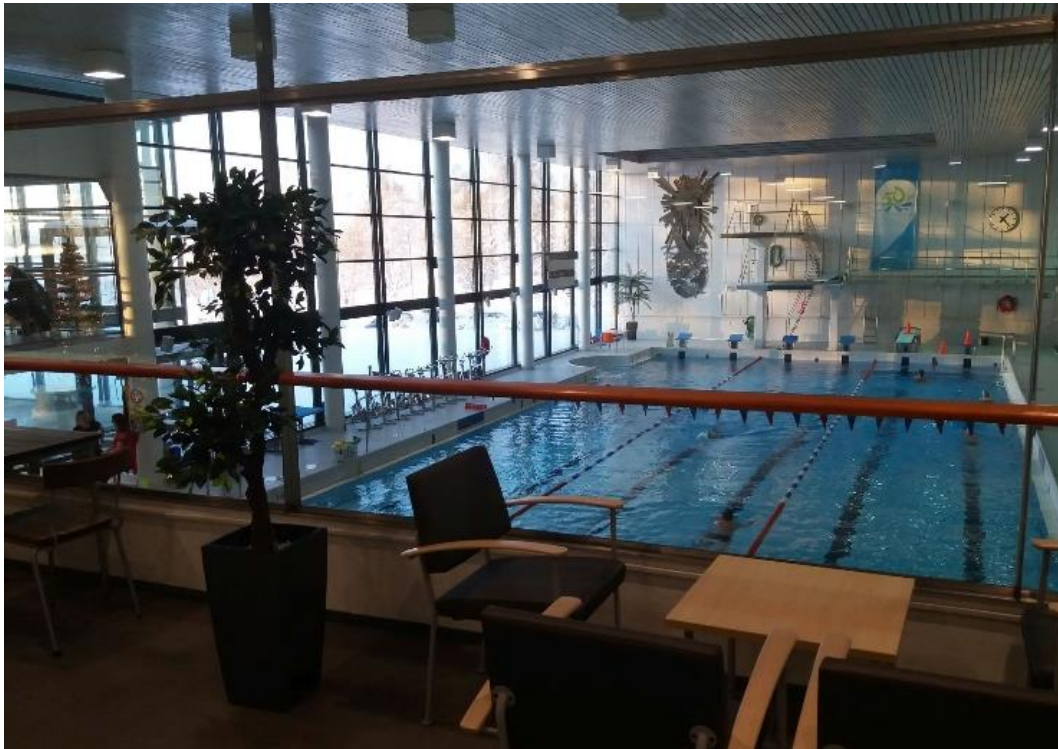
Kahviosta aukeaa lasiseinän kautta näkymiä allassaliin. Alkuperäisen idean mukaan kahviosta pysyy edelleen seuraamaan tapahtumia altaalla. Lasiseinän rakentaminen on ollut aulatilaa teknisesti parantava muutos, kostea allastila on erotettu aulasta ja kahviosta erilliseksi tilaksi. (Kuva Kemin uimahallin arkisto)
