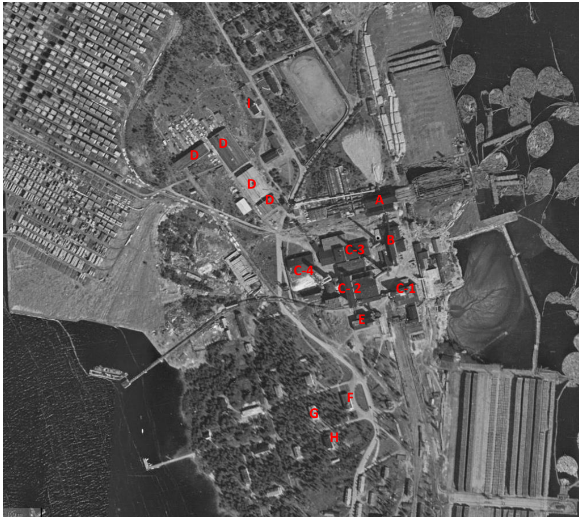
Kuva 13. Ote ilmakuva vuodelta 1946. A) saha, B) voima-asema, C-1) sulfiittiselluloosatehtaan kuorimo, C-2) sulfiittiselluloosatehtaan keitto-osasto, C-3) sulfiittiselluloosatehtaan kuivauskonesali, C-4) sulfiittiselluloosatehtaan varasto, D) puutalotehtaan rakennukset, E) sulfiittispriitehdas F) vanha pääkonttori, G) toimitusjohtajan asunto H) selluloosatehtaan johtajan asunto ja I) paloasema. Kuvälähde: Paikkatietoikkuna
